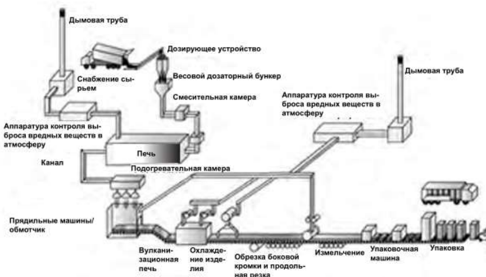
Рисунок 2.10: Типовая линия по производству стекловаты
