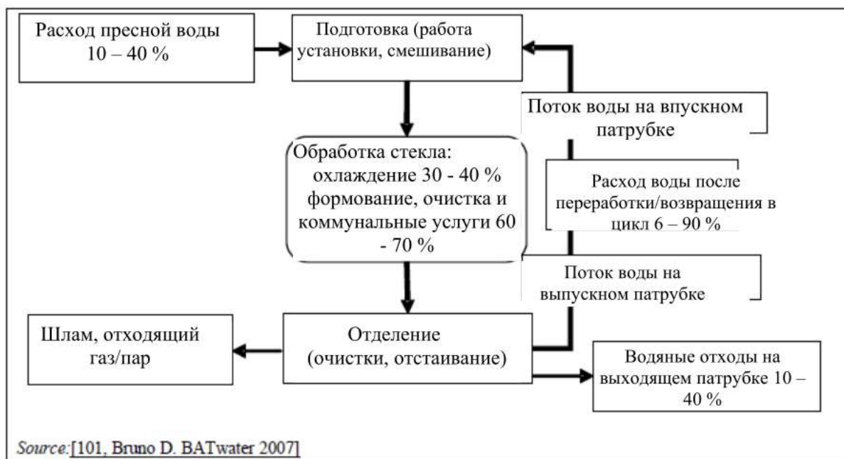
Рисунок 3.1: Типичное распределение воды при производстве стеклянной тары
