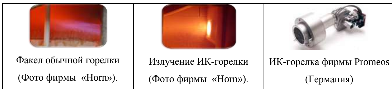
Рисунок 7.1. Сравнение обычной и ИК-горелки
