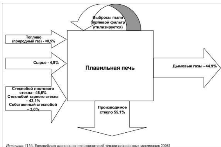
Рисунок Б.3. Графический баланс сырья для кислородно-топливной печи для производства стекловаты с рециклингом пылевого фильтра
