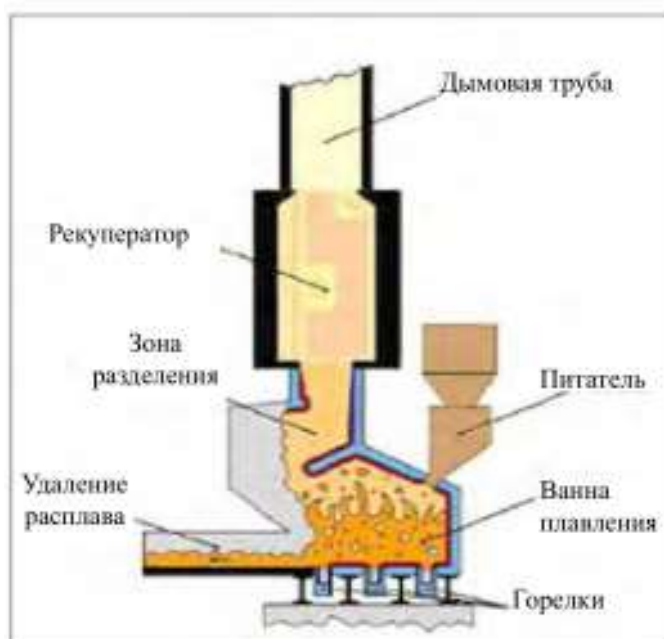
Рисунок 7.4: Принципиальная схема стекловаренной печи с погруженным горением
