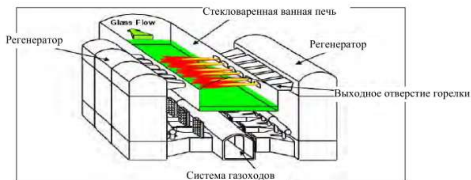
Рисунок 2.1: Стекловаренная ванная регенеративная печь с поперечным направлением пламени
