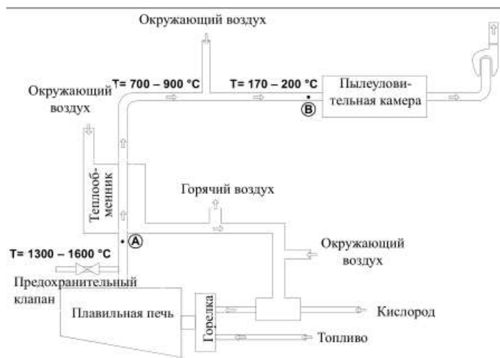
Рис. 2.15: Схематическое представление типовой стекловаренной печи для производства фритт с кислородным обогащением воздушно-топливного горения и восстановлением тепла
