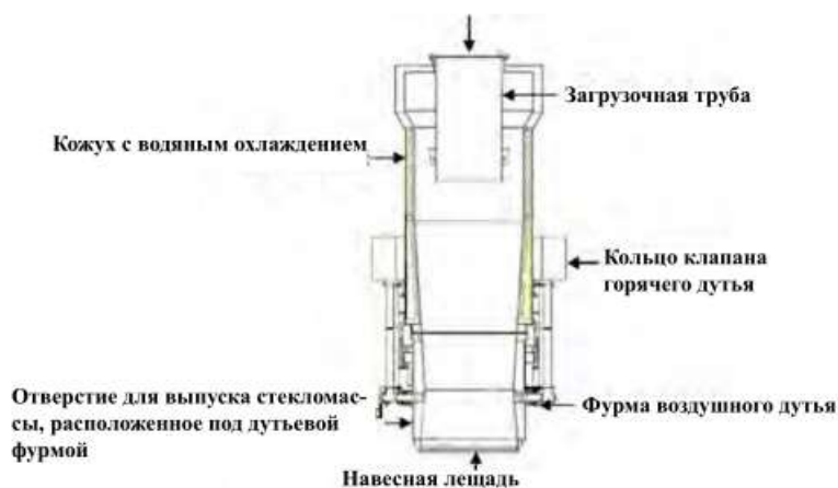
Рис. 2.13: Типовая вращающаяся печь с подогревом дутья
