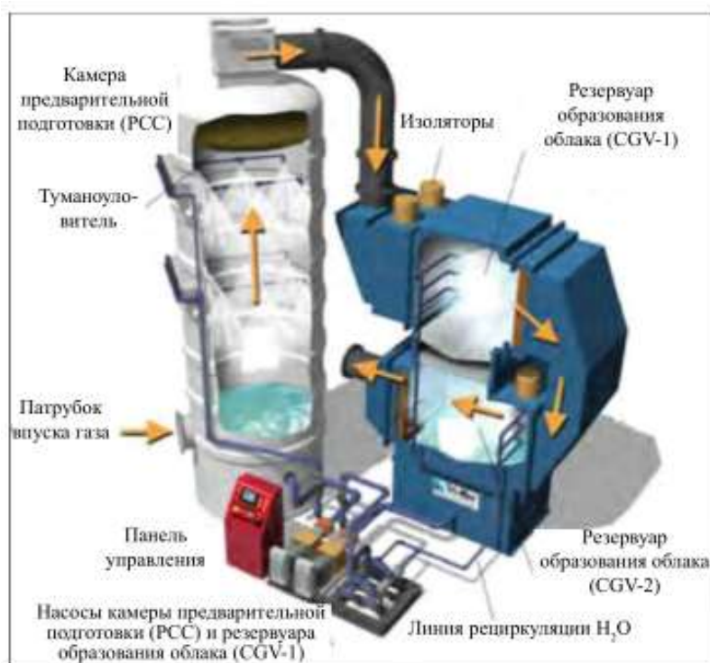
Рисунок 7.6. Принципиальная схема системы с заряженным облаком
